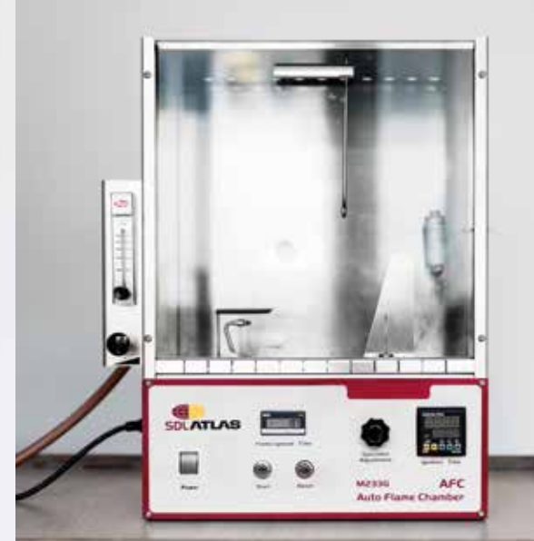
Flammtest / Brennbarkeitsprüfung ASTM D 1230
