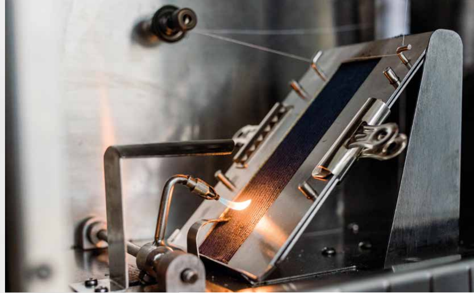
Flammtest / Brennbarkeitsprüfung ASTM D 1230
